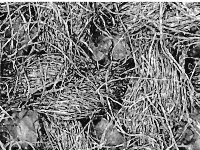
Figura 3. Compozit funcționalizat B2 prin imersarea țesăturii A în dispersia polimerică D2 pe bază de PVP/PEG și grafit. Analiza suprafeței prin microscopie digitală
