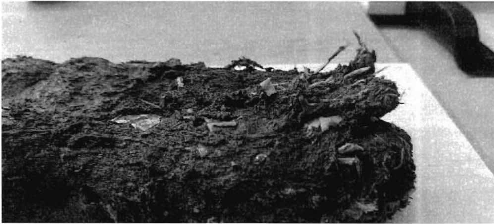
Fig. 1 MATERIAL ECO-INOATIV "DMP" – prima etapă de extrudare
