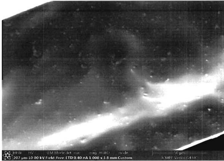
Figura 3. Imagine în secțiune a filmului compozit cu 30 % complex metalic, înregistrată cu un microscop electronic de scanare.
