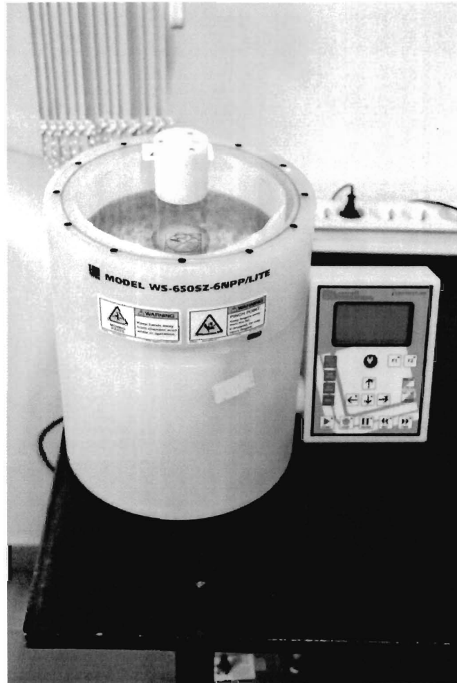
Fig. 1. Aparat utilizat pentru depunerea filmelor PbS1 și PbS2 pe substrat de sticlă și, respectiv, ITO.
