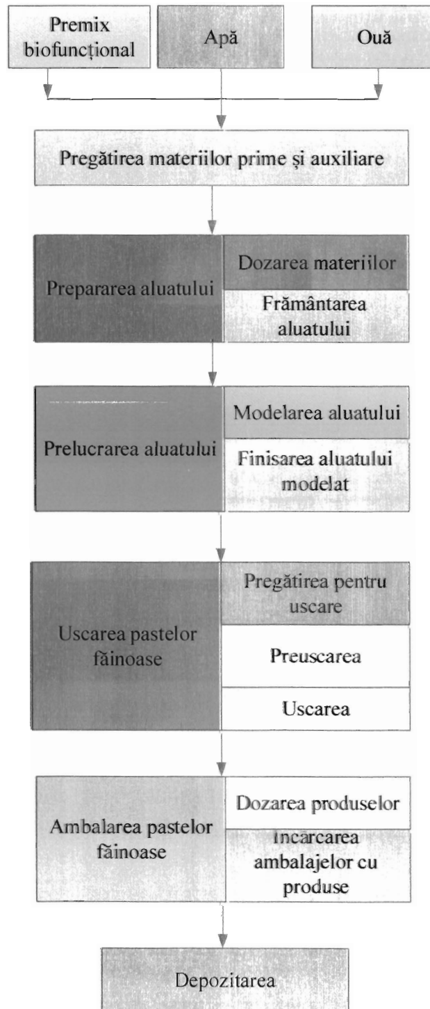
Figura 3. Schema tehnologică pentru obținerea pastelor pe bază de PMXBF
