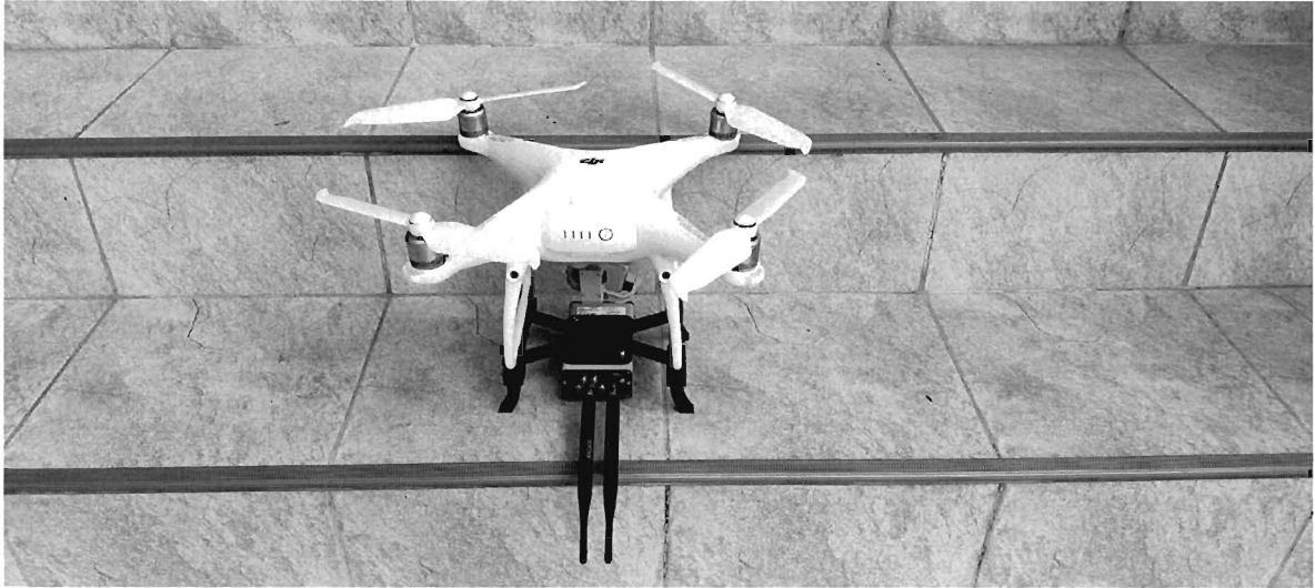
Figura 6. Dronă de apărare având atașată platforma SDR USRP E312
