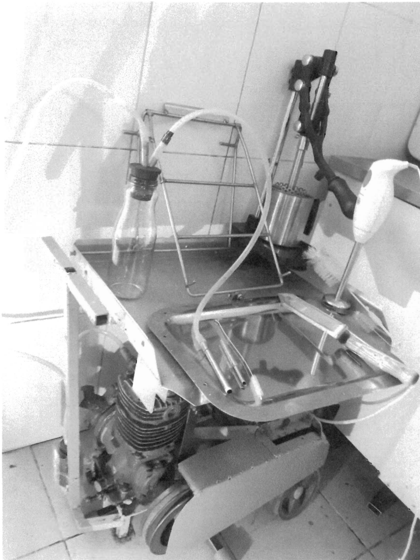
Fig. 3. Vedere de ansamblu asupra instalației de lucru ce are la bază recoltarea puietului căpăcit de trântor, ca produs proaspăt și congelat, cu ajutorul vacuumului.
