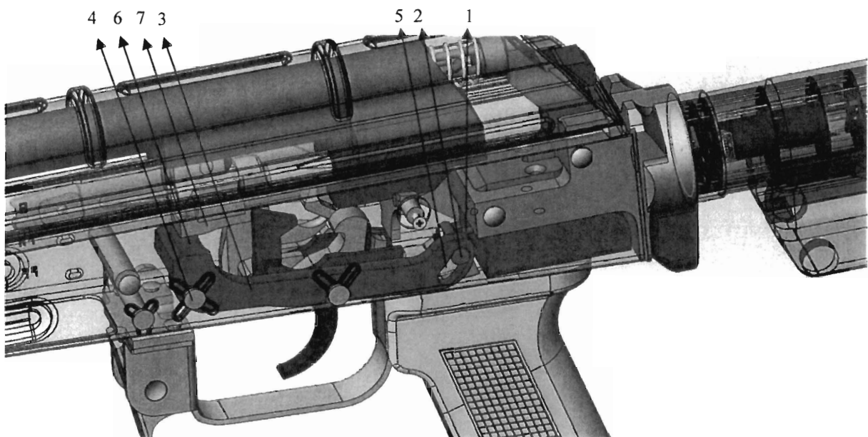
Figura 2 – Vedere izometrică mecanism de blocare-deblocare
