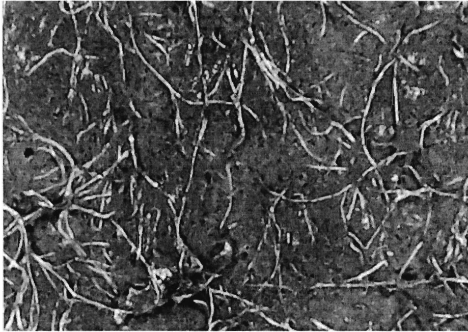
Figura 1. Compozit funcționalizat prin depunerea peliculei polimerice B se suprafața țesăturii A. Analiza suprafeței prin microscopie digitală
