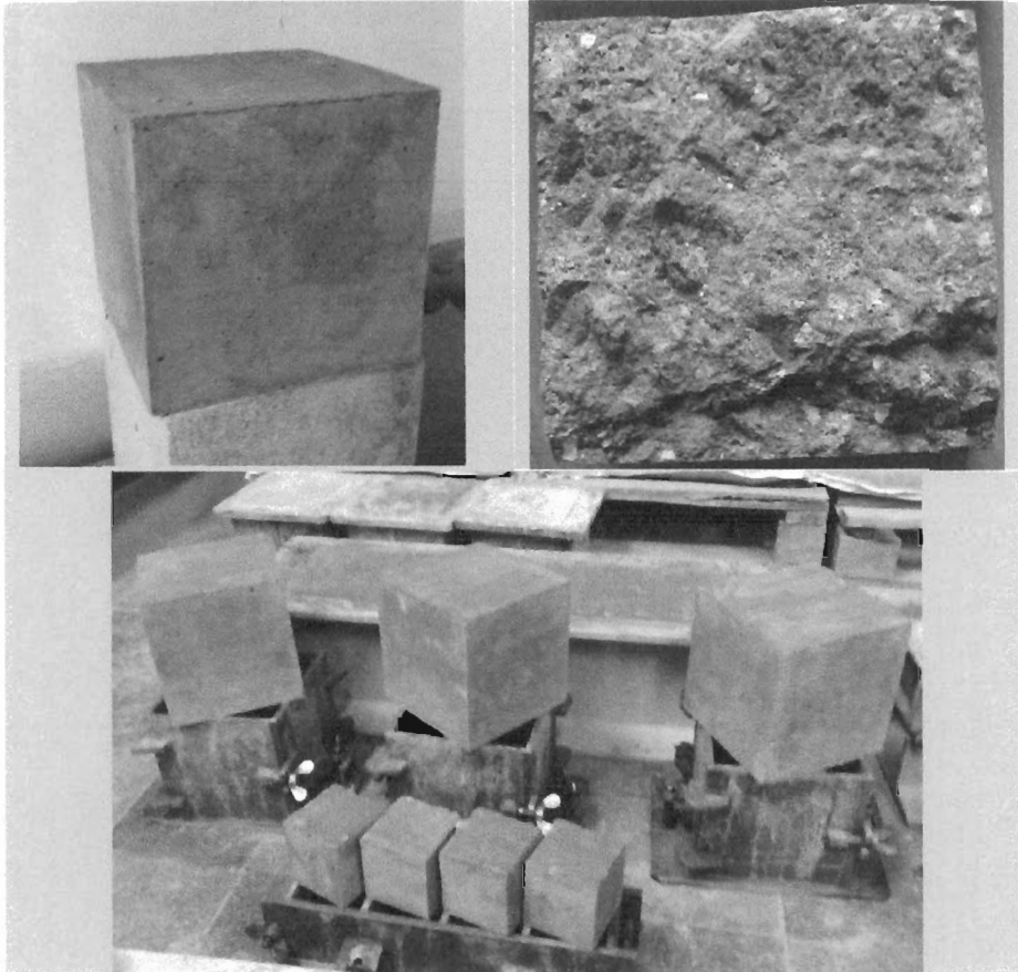
Figura 1. Betonul rutier inovativ BcR_G colorat verde, în masă
