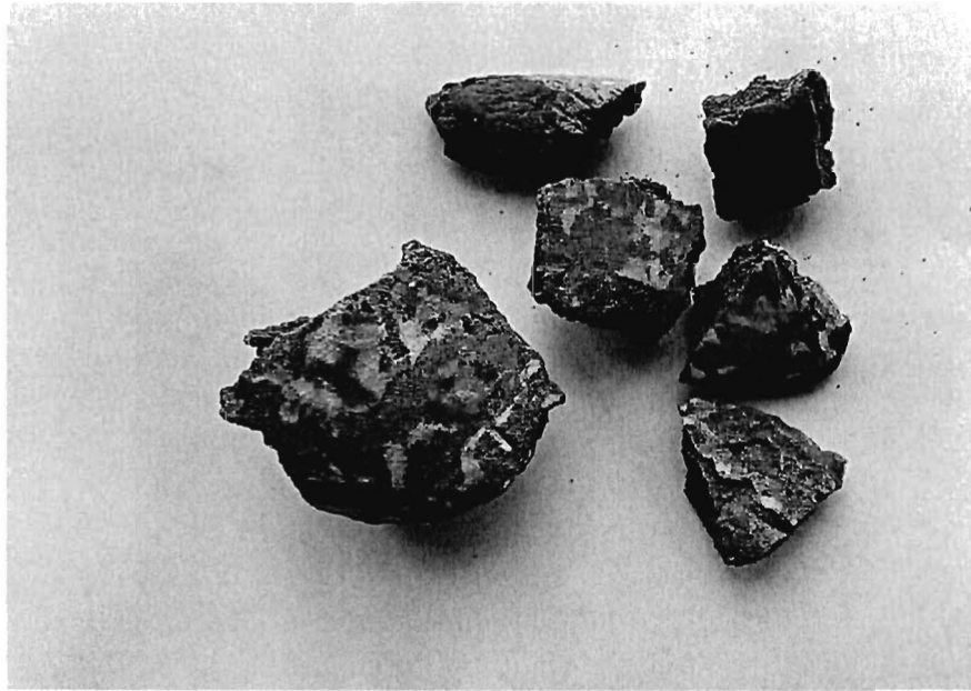
Figure 1. Exemplificare material obținut din praf de piatră cu deșeuri din plastic.
