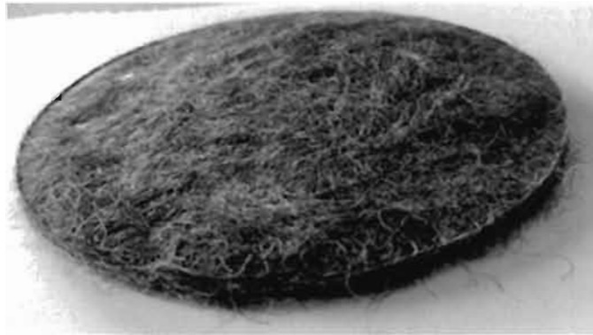
Figura 2. Placă din fibre de lână obținută prin presare la cald.
