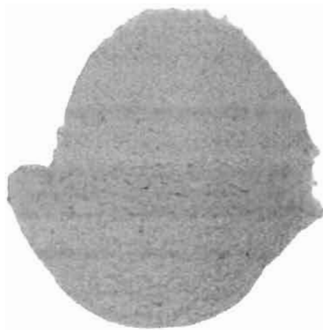
Fig. 2. Componenta B: sticlă sub formă de cioburi sfărâmate prin implozie, concasate.
