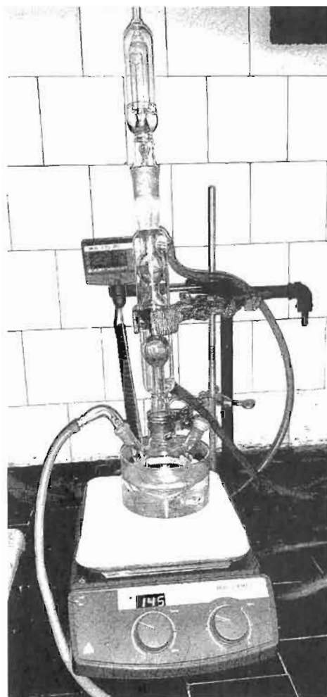
Figura 3. Instalația de laborator generală folosită pentru producerea grafenelor funcționalizate cu azulenă
