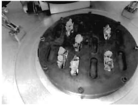
Fig. 1. Încărcătura metalică pe platanul de cupru al instalației RAV.
