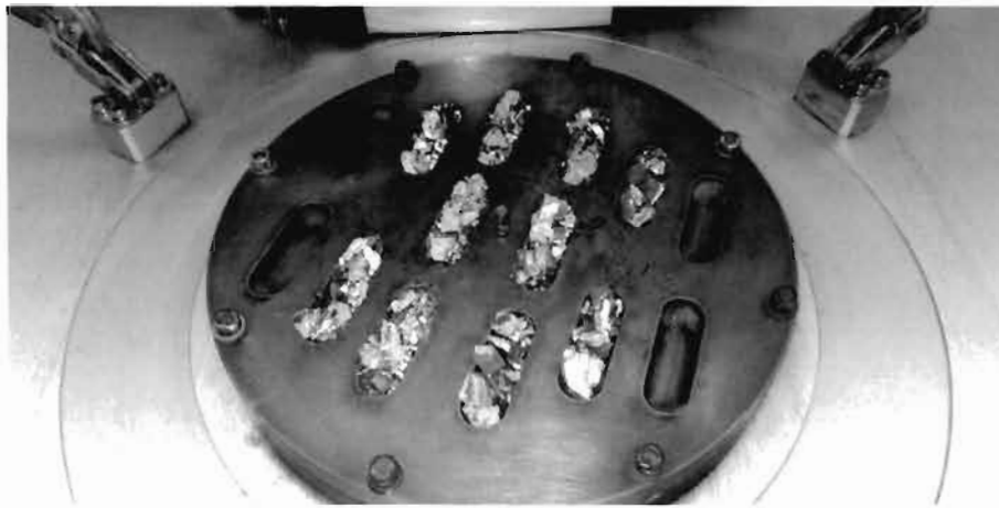
Fig. 2. Placa din cupru răcită cu apă în care se așează materialele metalice ale încărcăturii în vederea topirii aliajelor cu entropie ridicată sub mediu inert de argon în instalația RAV.
