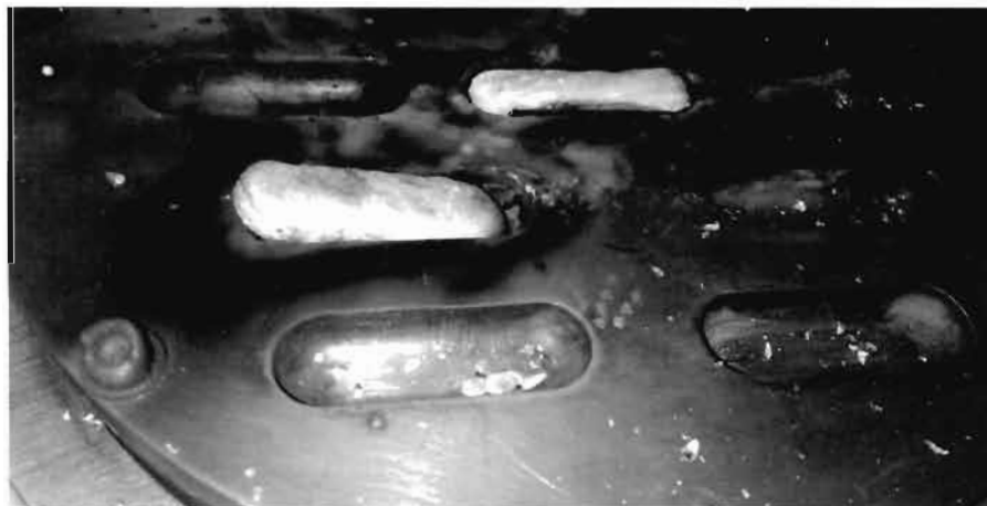
Fig. 3. Probe din aliaj metalic biocompatibil multielement MoNbTaTiZr obținute prin topire în instalație RAV.
