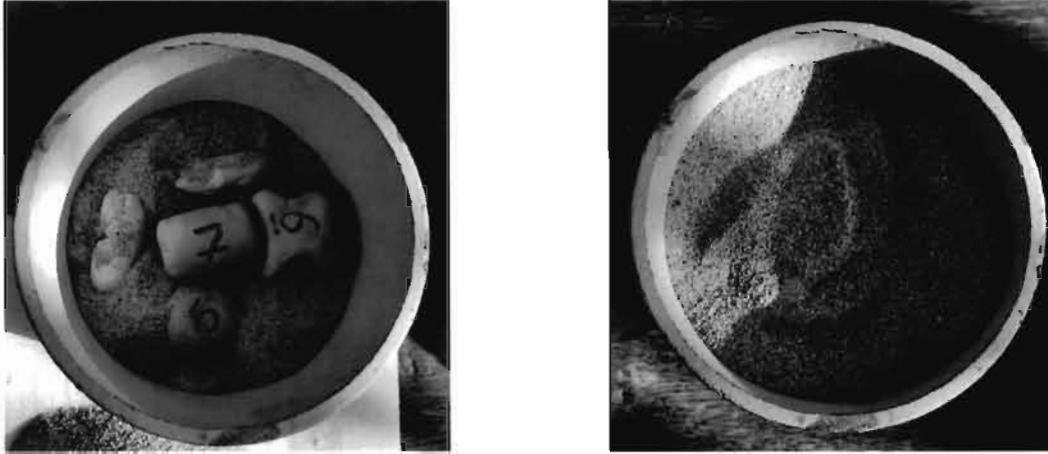
Fig. 5. Introducerea probelor împachetate în creuzet metalic sub strat de nisip cuarțos.
