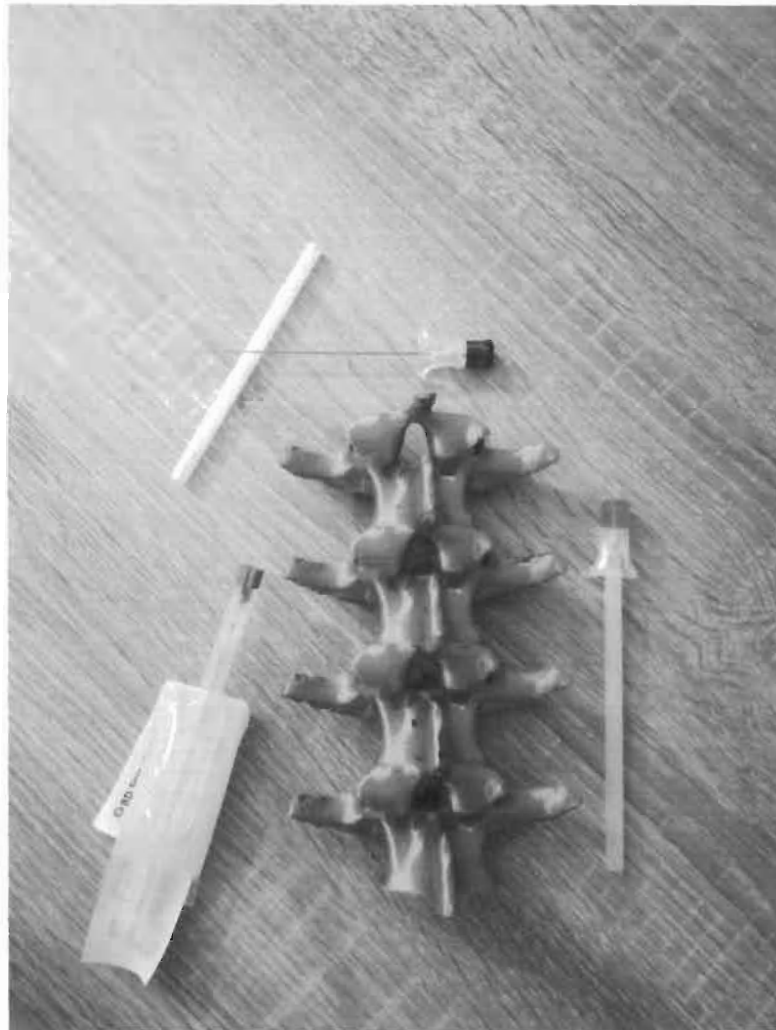
Figura 1. Structura vertebrelor lombare din acid polilactic utilizate pentru realizarea scheletului mulajului.
