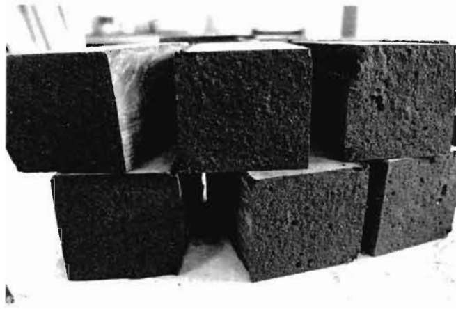
Fig. 7. Liantul geopolimer la finalul etapei de tratament termic - secțiune transversală
