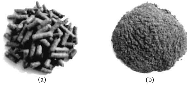
Figura 1. Shrot rapita-materia prima utilizata in procesul de piroliza: (a)-extrudate; (b)-particole cu dimensiunea \leq 1\text{mm} ;
