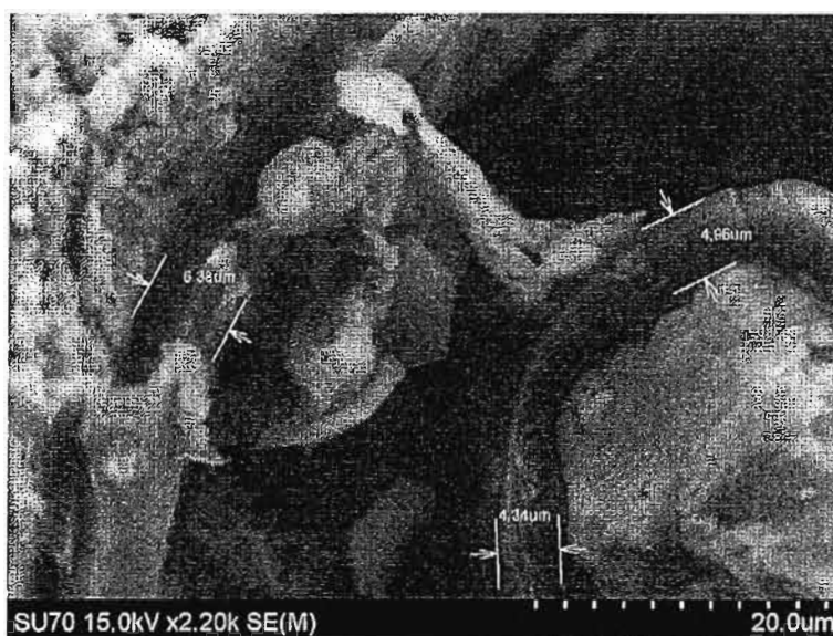
Fig.4. Imagine SEM a unei zone vindecate a materialului, cu formarea hidrosilicaților de calciu suplimentari
