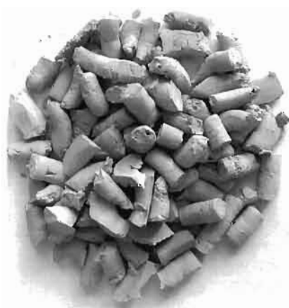
Figura 3. Imaginea catalizatorului Fe 2 O 3 /P/ZSM-5 obținut sub forma de extrudate
