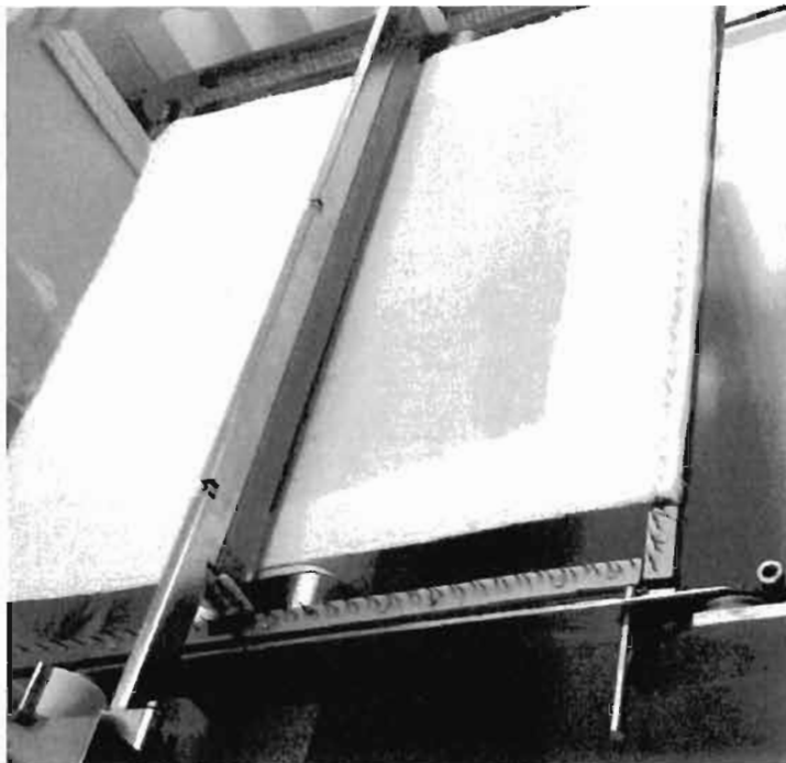
Figura 1. Funcționalizarea suprafeței textile prin peliculizare cu pastă polimerică pe bază de microparticule de argint
