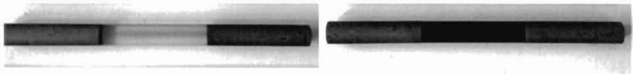
Fig. 1. Epruvete de rășină epoxidică (stânga) și compozit cu carbon activ (dreapta)
