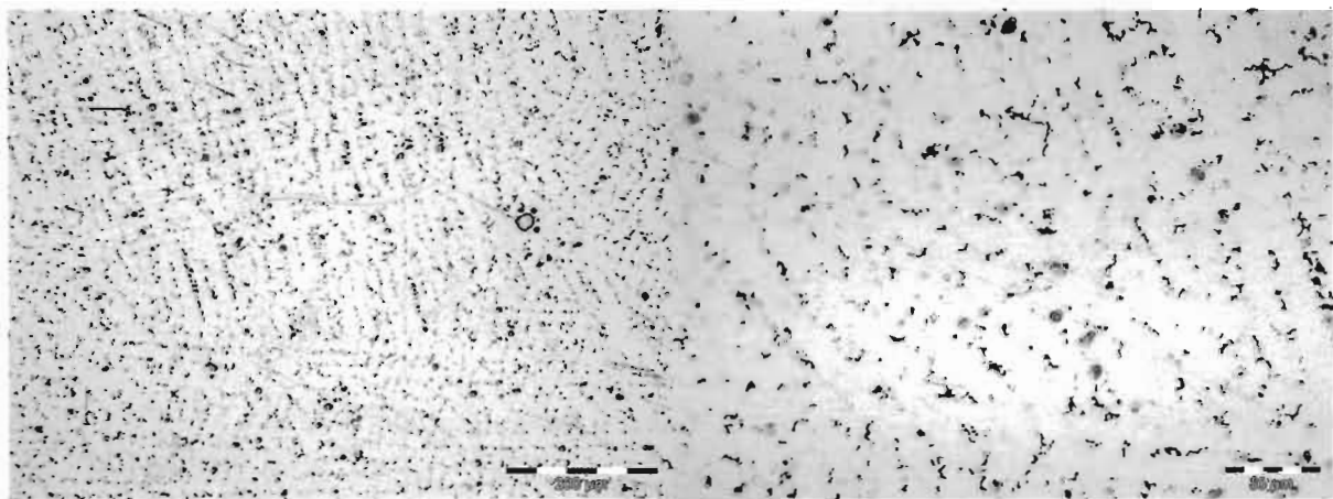
Fig. 2. Aspecte microstructurale obținute cu ajutorul microscopiei optice, corespunzător aliajului experimental din sistemul CoCrMN.
