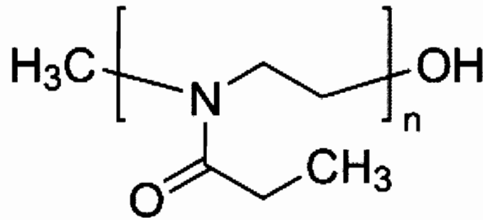
Fig. 3 - Formula structurală a poli(2-etil-2-oxazolinei)
