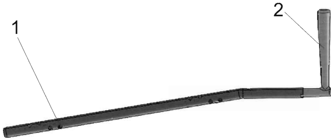
Fig.1. Modelul tijei cu mecanism roata dințată-cremalieră: 1- corpul tijei cu mecanismele; 2-cheia de acționare.
