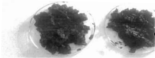
Fig nr.2 Nămol centrifugat folosit pentru obținere cărămidă
