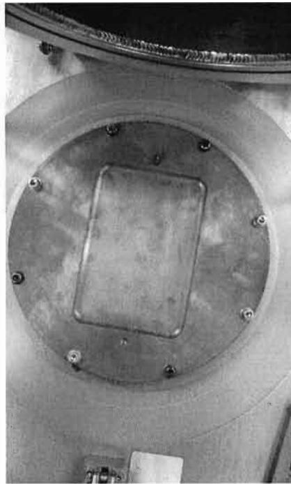
Fig. 1. Placa de cupru a instalației RAV - VAR pentru obținerea materialului metalic FeCrAl microaliat cu Zr, Y, Hf și Ti.
