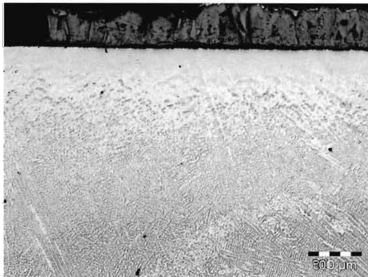
Fig. 6. Aspectul stratului prelucrat cu laser în secțiune transversală. Dendrite fine orientate cvasi-perpendicular pe suprafața și strat de oxid format superficial (50x).
