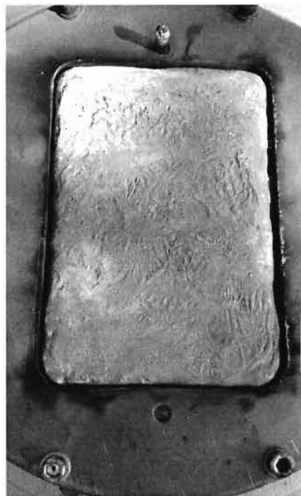
Fig. 2. Material metalic multicomponent FeCrAl microaliat cu Zr, Y, Hf și Ti, obținut în instalația RAV - VAR.
