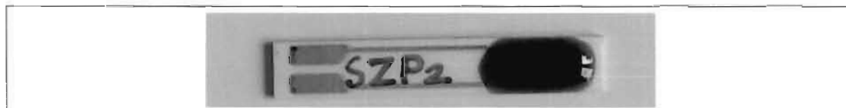
Figura 2. Depunerea prin picurare (drop-casting) din solutie a materialului SZP sensibil la metan.
