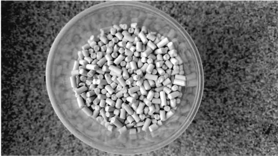
Figura 4. Material zeolitic mezoporos cu activitate catalitica ridicata obtinut conform prezentei inventii (Ciclul 1 complet, repetat de 12 ori)
