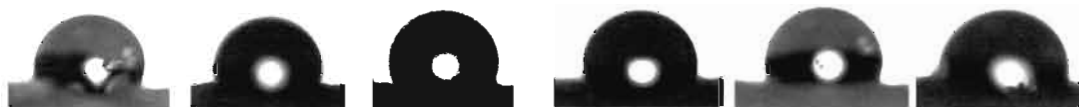
a) CA=91,51^\circ b) CA=86,28^\circ c) CA=95,48^\circ d) CA=83,18^\circ e) CA=90,40^\circ f) CA=84,82^\circ
