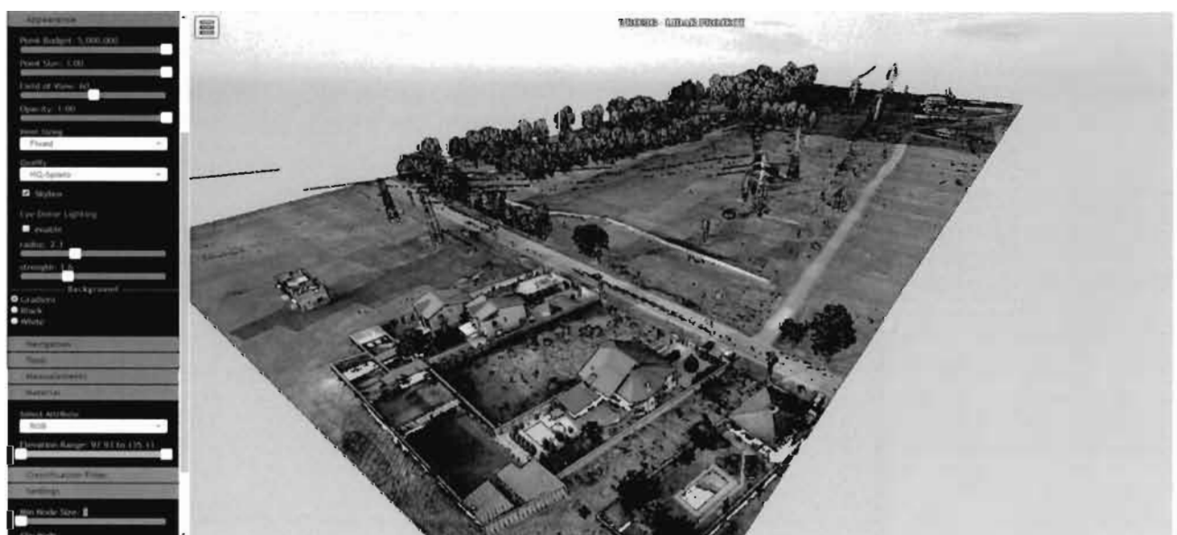
Figura 5. Conturarea construcțiilor și a altor obiecte de peisaj prin mărirea factorilor de contrastare
