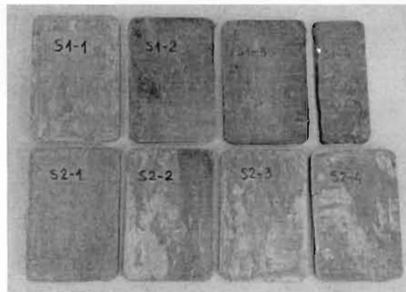
Fig. 2. Plăci din aliaj metalic multielement AlCrFeCoNi obținute prin turnare din materialul elaborat în cuptorul cu inducție.
