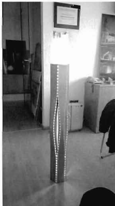
Fig. 2 Produs metalic tip coloană ștanțat cu perforații alungite luminat intern
