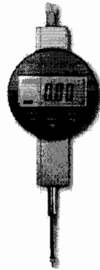
Fig.4. Comparatorul pentru măsurarea diametrelor interioare și exterioare mari cu afișare digitală
