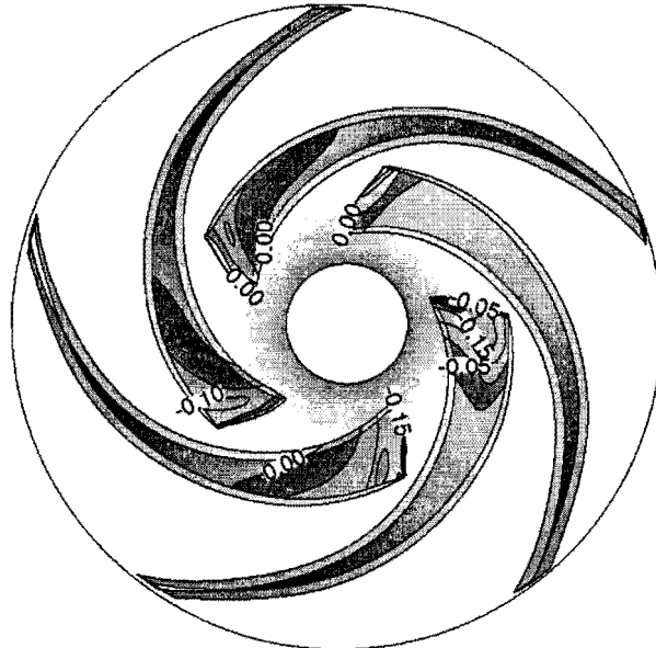
c) impulsor cu 8% turație mai mare față de turația rotorului de pompă
