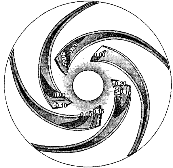
b) impulsor cu 8% turație mai mică față de turația rotorului
