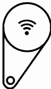
Fig. 5. Varianta 1 de realizare fizică a cardului RFID pentru acces, armare și dezarmare
