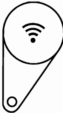
Fig. 7. Varianta 1 de realizare fizică a cardului RFID pentru acces, armare și dezarmare
