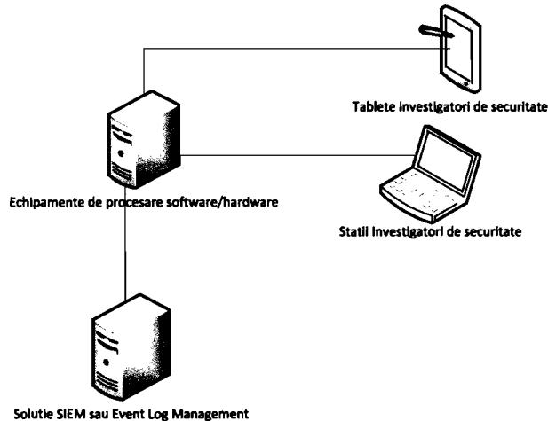
Appliance-ul de procesare are rolul de a extrage datele din sistemul SIEM am beneficiarului. Odata extrase, aceste date vor fi stocate intr-o structura de tip not-only-sql DB si se vor aplica algoritmi de procesare pe tot volumul de date.
