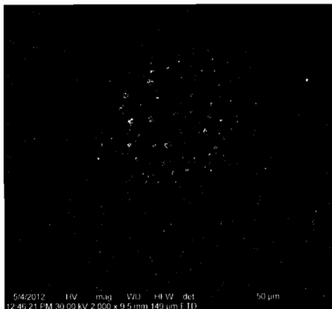
Figura 6. Imaginea SEM a electrodului Au-Ppy dupa ciclarea electrochimica.
