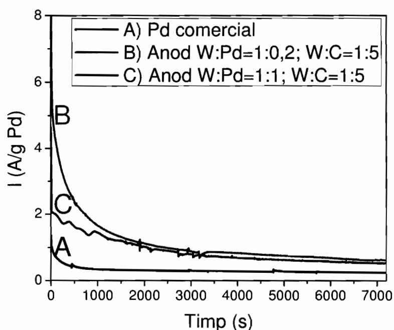
Figura 2. Testare cronoamperometrică a anozilor descriși în exemplul 1 și 2 față de standardul de paladiu comercial în acid formic+acid sulfuric 0,1M la un potențial de 0,1 V față de Ag/AgCl (3M)
