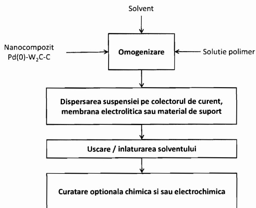
Figura 1. Schema de obtinere a anozilor pentru electrooxidarea acidului formic folosind nanocompozite Pd(0)-W<sub>2</sub>C-C
