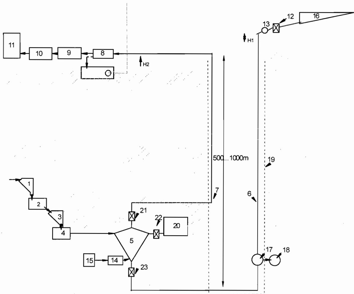
Fig. 1. Schema sistemului de extracție la suprafață a cărbunelui energetic, ce utilizează o pompă gravitațională
