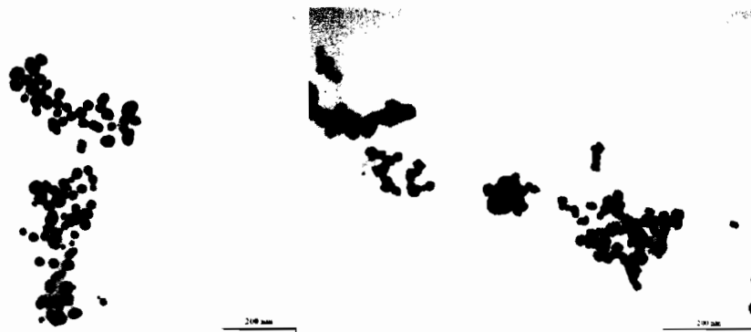
Figura 2. Imagini TEM ale: AuNPs-coarne; AuNPs-sanger (scara 200 nm) (dimensiunea nanoparticulelor: dimensiunea medie 81% 29-32 nm; 88%-21-26 nm).
