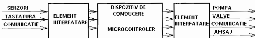
Fig.2. Mărimile de intrare și ieșire din dispozitivul de conducere (microcontroler)
