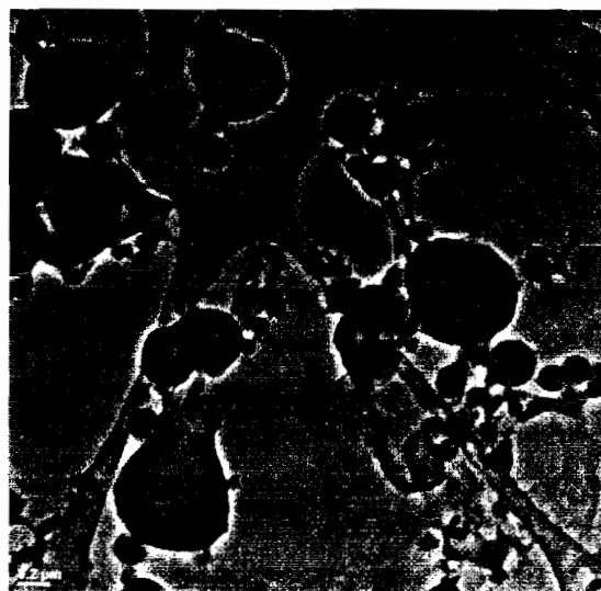
Figura 2. Imagine de microscopie electronică prin transmisie (TEM) a polimerului PU-SH tratat hidrotermal.
