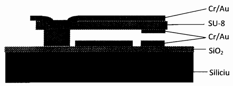
Figura 1: Dispozitiv de tip micro-switch, cu tensiune de actiune de aproximativ 5 V.
