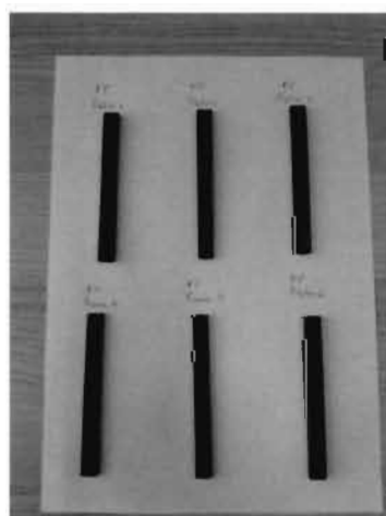
Figura 2 Exemple de probe de materiale termoplastice compozite obtinute in diferite concentratii de deseuri combinate de plastic si hartie, continand polipropilena si resturi celulozice in procent de 2, 5, 10 si 20% - raportate la masa ambalajului combinat inseparabil tip deseou.
