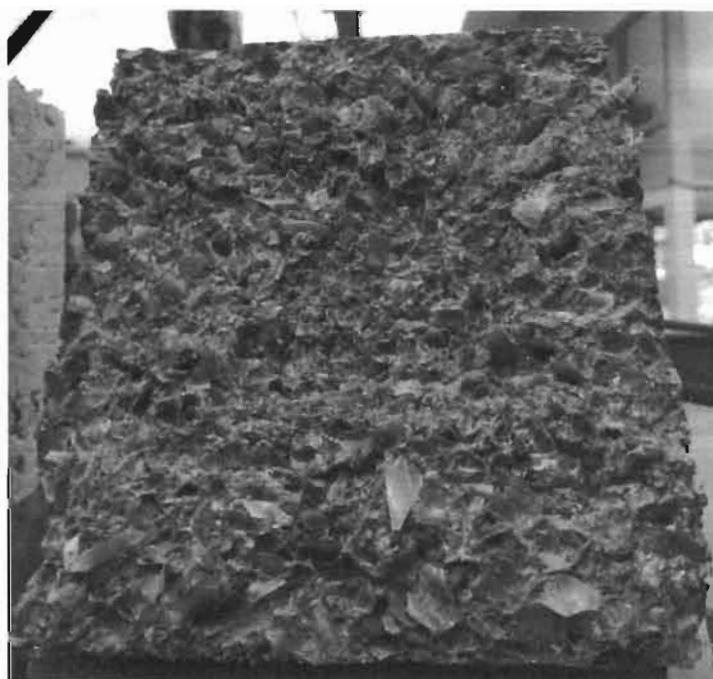
Figura nr. 2 Aspectul unui cub de beton în urma încercării
